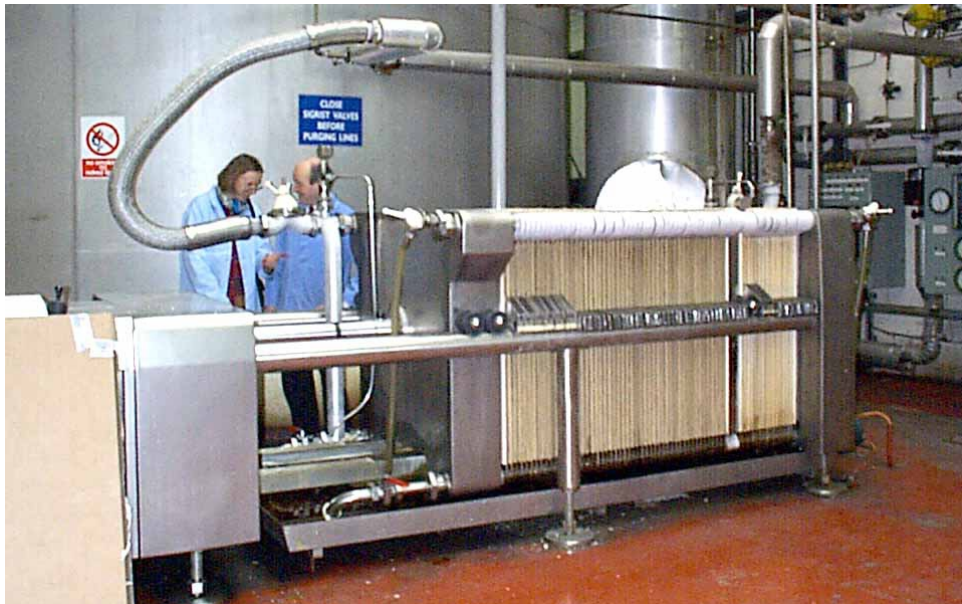
Foto 1. Industrieller Whiskyfilter mit mehr als 20 Lagen
