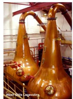
der Alkoholgehalt der jetzt Low Wines genannten Flüssigkeit auf stolze 20 bis 25% erhöht. Die Low Wines pumpt man in die zweite Brennblase, die Spirit Still. Die in der Wash Still übrig gebliebene Flüssigkeit hat weniger als 1% Restalkoholgehalt und enthält noch immer viele Nährstoffe. Sie wird von Viehzüchtern gerne als Futter verwendet.
