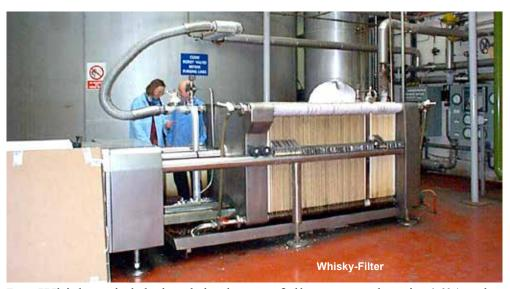
Der Whisky wird dadurch in der Regel leichter und weicher, was dem Genießer oft (nicht immer) entgegen kommt. Dieses Verfahren nennt man Kühlfilterung.
